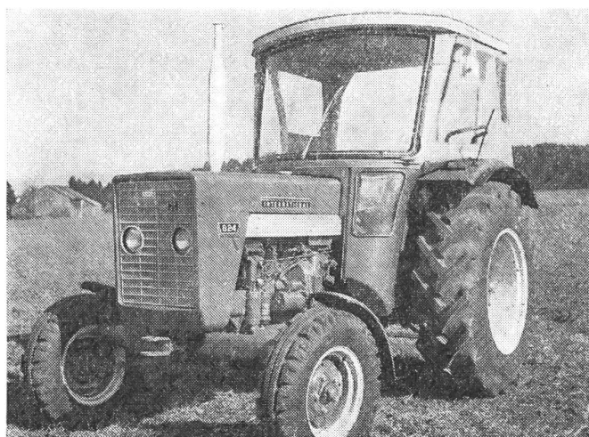
Mit Wetterschutzverdeck versehener Rahmen. Einstiegsmöglichkeit von vorn.
