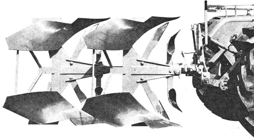
Tausendfachbewährte, unübertroffene halbautomatische Wendevorrichtung. Grosser Durchlass zwischen den Pflugkörpern. Beide Furchen in der Breite genau einstellbar. Riestern aus chromlegiertem Panzerstahl, gegen Abnützung besonders widerstandsfähig. Zuverlässige Bruchsicherungen.
