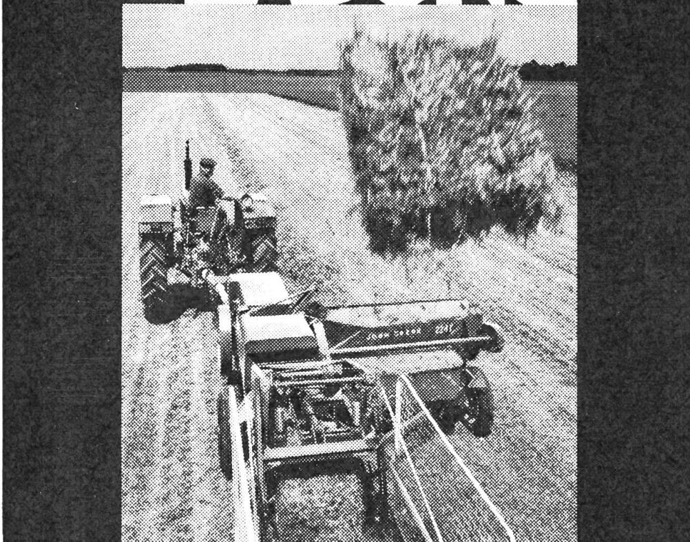
Grosse Ballen, kleine Ballen. Mit der John Deere Hochdruckpresse 224 ist das kein Problem mehr. Sie können bei dieser Presse die Grösse der Ballen stufenlos einstellen. Von 0,30 bis 1,27 m.
