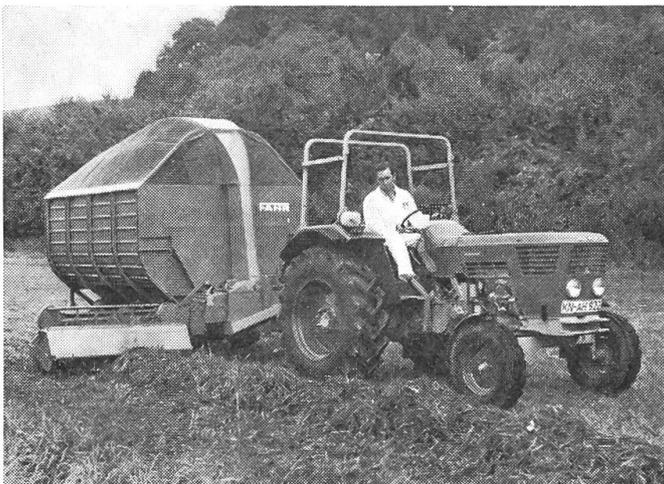
Abb. 1: Dem Häckselwagen HW 35 stehen als Vorsatzgeräte wahlweise das Pic-up, die Maismähvorrichtung, der Kolbenpflückschroter oder der Rübenköpfschlitten zur Verfügung. (Werkphoto)
