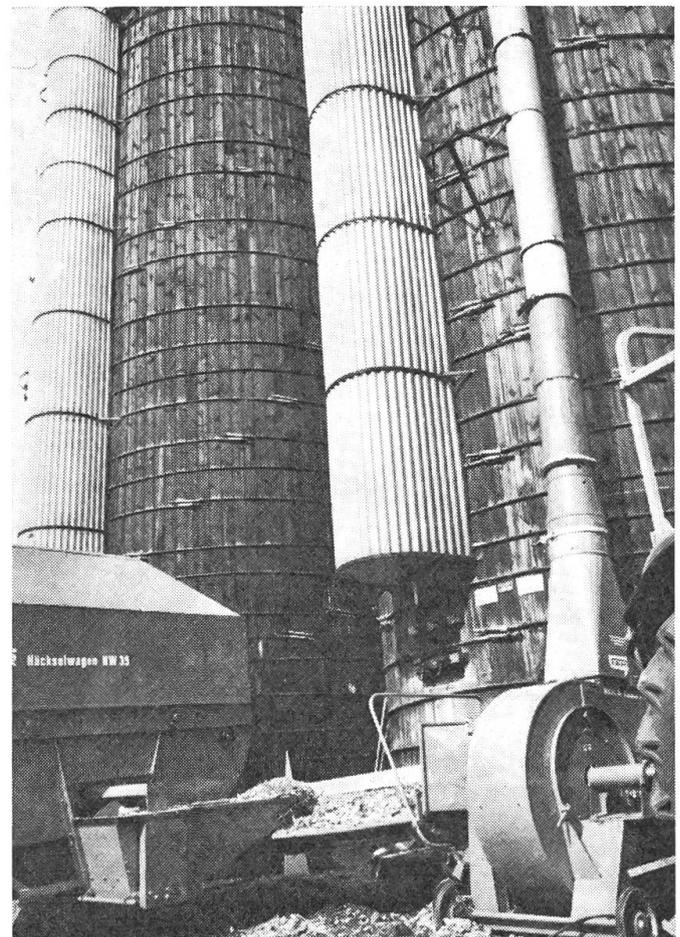
Abb. 3: Hinten am Häckselwagen ist ein Querförderer zum Beschicken von stationären Gebläsen angebaut. Ein Gebläse zum Beschicken des Hochsilos kann auch direkt montiert werden, mit dem Vorteil, dass das Siliergut unter Ausnützung der vorhandenen Traktor-PS weitergefördert werden kann. (Photo V. Monhart)
