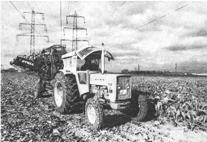
Abb. 1: Der einreihige Bunkerköpfröder, in Einmannarbeit dank hydraulischer Bedienung einzusetzen, beherrscht nach wie vor die Zuckerrübenernte. Erst vereinzelt arbeiten mehrreihige Rübenroder entweder als gezogene Geräte oder als Selbstfahrer. Auch das sechsreihige französische Ernteverfahren mit 3 einzeln eingesetzten Geräten (Köpfen - Roden - Aufladen) hat Anhänger gefunden. Foto: W. Schiffer
