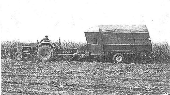
Abb. 2: Beim Häcksler-Ladewagen Landsberg werden die Arbeitsgänge Häckseln, Transportieren und Ab-
