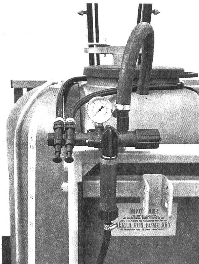
An der vergangenen Royal Smithfield Show (London 4.–8.12.1972) war ein neues Steuergerät für Traktoranbau-Spritzen zu sehen. Das Gerät kann an die Schädlingsbekämpfungsspritzen der unten genannten Firma angeschlossen werden. Dank einer Ansaugvorrichtung verhindert es das Ausfließen von Spritzbrühe und somit die bekannten Verbrennungen an den Pflanzen.
