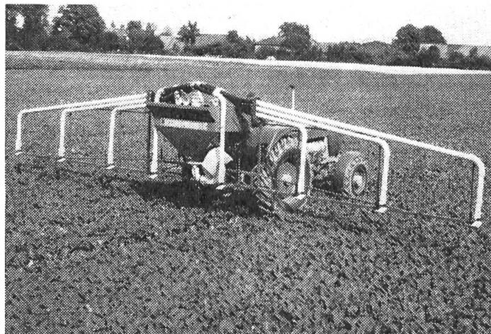
Dieser moderne, pneumatische Düngerstreuer streut **alle gekörnten Dünger mit einer unerreichten Genauigkeit von 4–6%** in Breiten von 10 und 12 m bei hoher Fahrgeschwindigkeit. Die Streumenge lässt sich genau regeln zwischen 85 und 1500 kg/ha. **Kombinierbar als Breit- und Reihenstreuer besonders geeignet für Maiskulturen.** Der ideale Düngerstreuer für Grossbetriebe und für Genossenschaften.
