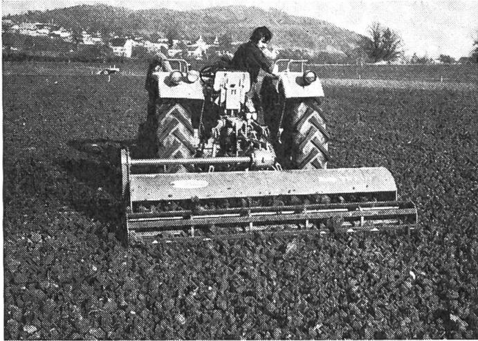
Abb. 11: Das Arbeitsorgan einer Taumelwälzgege besteht aus hin und her schwenkenden Zinkensternen. Mit der Egge wird das Absetzen des frischgepflügten Bodens beschleunigt.
