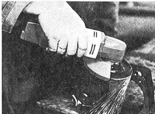
Der Einhandwinkelschleifer soll nur als Zweitmaschine in Betracht gezogen werden, weil er als Einzelmaschine dauernd überfordert würde.
