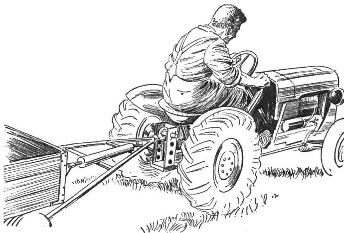
Abb. 7: Tetrax-Bremsbetätigung (hydraulisches Prinzip). Nachdem alle Traktoren nunmehr eine Hydraulikanlage aufweisen, erscheint es naheliegend, diese auch zur Bremsung auszunützen.
