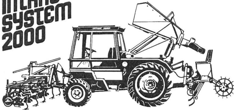
Ein echtes Selbstfahrer-System · Mit einem abgestimmten Geräteprogramm, das mehrere Arbeitsgänge zu einem Arbeitsablauf kombiniert · 3 Anbau Räume (Frontanbau Raum, zentraler Anbau Raum, Heckanbau Raum) · Hydraulik vorn und hinten mit DEUTZ-HITCH · Unabhängige Zapfwelle vorn und hinten · Gerätewechsel vom Fahrersitz aus · Die Basismaschine mit der perfekten Einmannbedienung.
