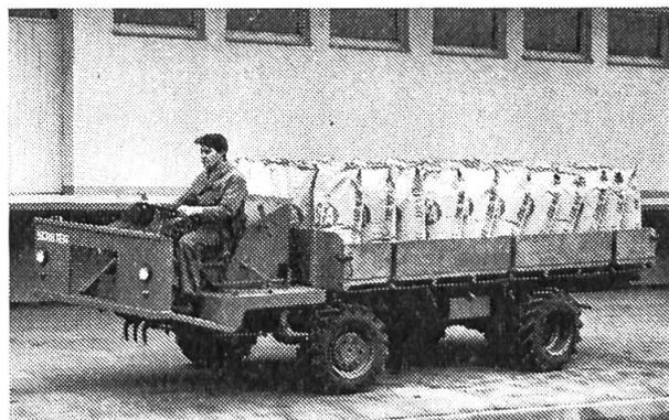
Man sieht ihm seine Zuverlässigkeit auf den ersten Blick an, dem SCHILTER LT. Und er bestätigt sie tagtäglich durch seine treuen Dienste: Als kletterfreudiger Ladetraktor mit dem extra-grossen Laderaum. Als Zug- und Geräteantriebsmaschine mit dem starken 40-PS-Dieselmotor, dem robusten Getriebe und den Ritzelachsen. Als Transporter mit hoher Tragkraft und grossen Sicherheitsreserven.
