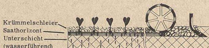
Die RAU-KOMBINATION mit SW-Stegwalzenkrümmer bereitet stets einen idealen Saathorizont, mit wasserführender Unterschicht und einem obenauf liegendem Krümmelschleier.
