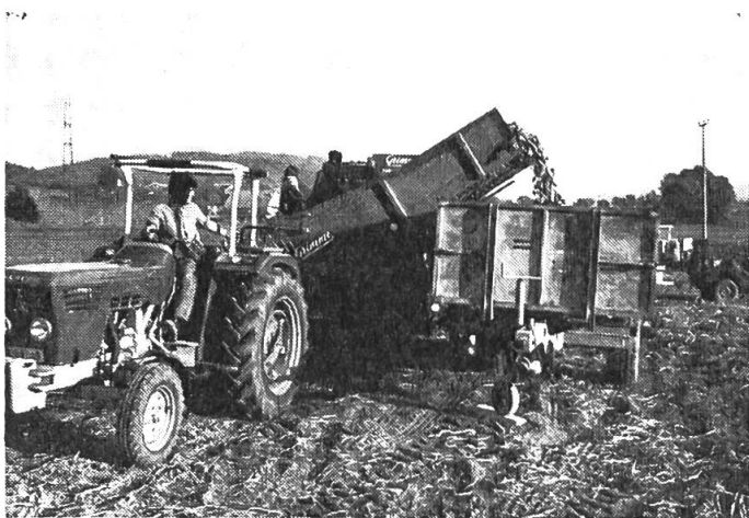
Abb. 6: Kartoffelvollernter mit Rollbodenbunker. (Foto FAT)
