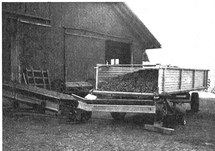
Abb. 9: Kastenwagen mit Abladeteppich ermöglichen ein schonungsvolles Entladen der Kartoffeln.
