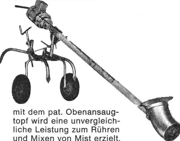
mit dem pat. Obenansaugtopf wird eine unvergleichliche Leistung zum Rühren und Mixen von Mist erzielt. Die grosse Ansaugöffnung ist frei von der sonst üblichen durchgehenden Antriebsnabe.
