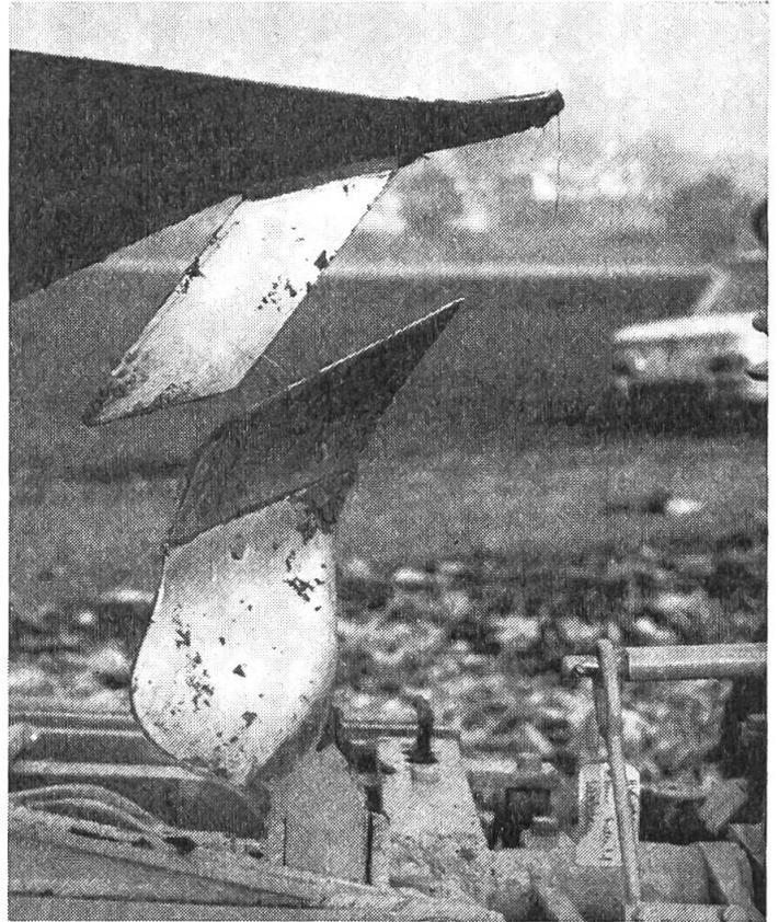
Abb. 8: An der Pflugschar befestigtes Kurzsech.
