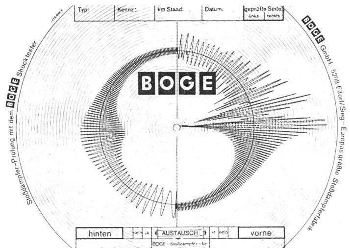
Dieses Bild zeigt zwei mit dem BOGE-SHOCKTESTER gemessene Dämpfer gleichen Typs, von denen der Linke 100 % Leistung, der Rechte, infolge Verschleiss und Defekts, nur noch 50 % Leistung besitzt.
