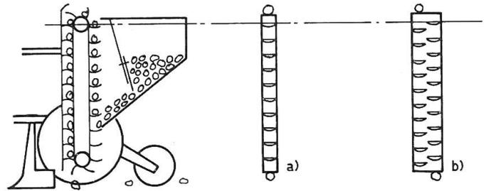
Abb. 2: Legeautomat mit a) einfacher und b) doppelter Becherkette oder -gurte
