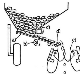
Abb. 4: Legeautomat mit Schöpfwalze und Gurtenablage
