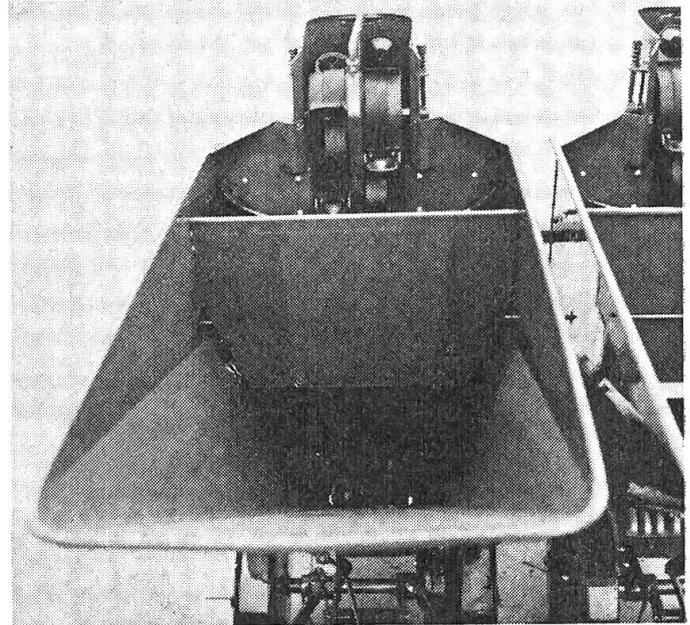
Abb. 11: Saatgutbehälter und Doppelbechergurten des Legeautomaten Gruse
