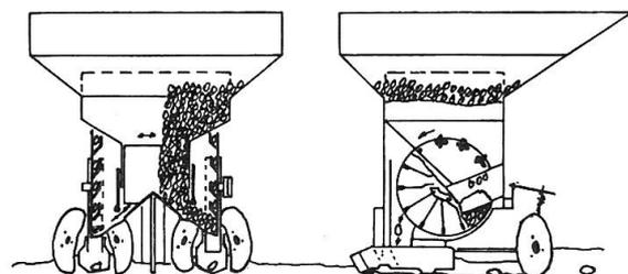
Abb. 5: Legeautomat mit Greiferrad
