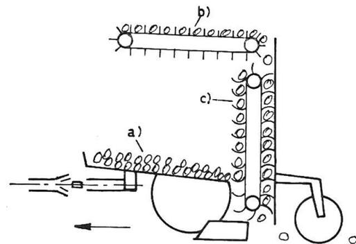
Abb. 3: Legeautomat mit Vibrationstisch und Gabelkette (System Besson) a) Vibrationstisch b) Fehlstellenausgleich c) Gabelkette
