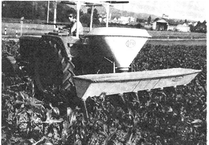
Abb. 4a: Pendelstreuer Vicon mit vierreihiger Streuvorrichtung.
