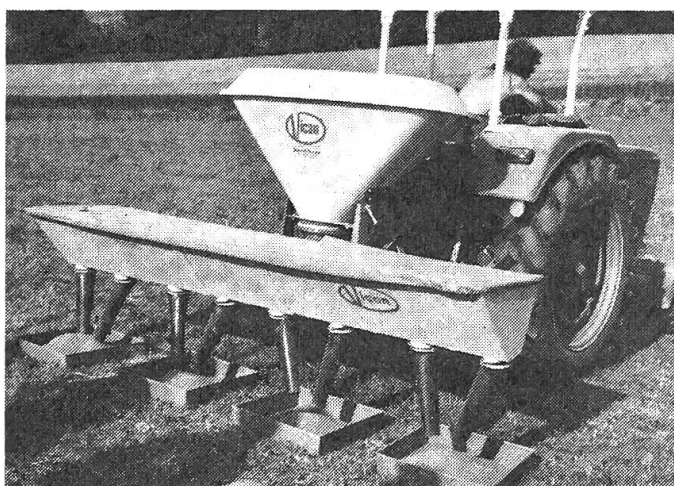
Abb. 1: Versuchsanordnung zur Ermittlung und Kontrolle der Düngerverteilung auf die einzelnen Reihen beim Reihenstreuer Vicon im Hanggelände.
