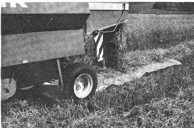
Abb. 5: Dreschwerkverlustbestimmung bei Mähdrescherversuchen an der FAT.
