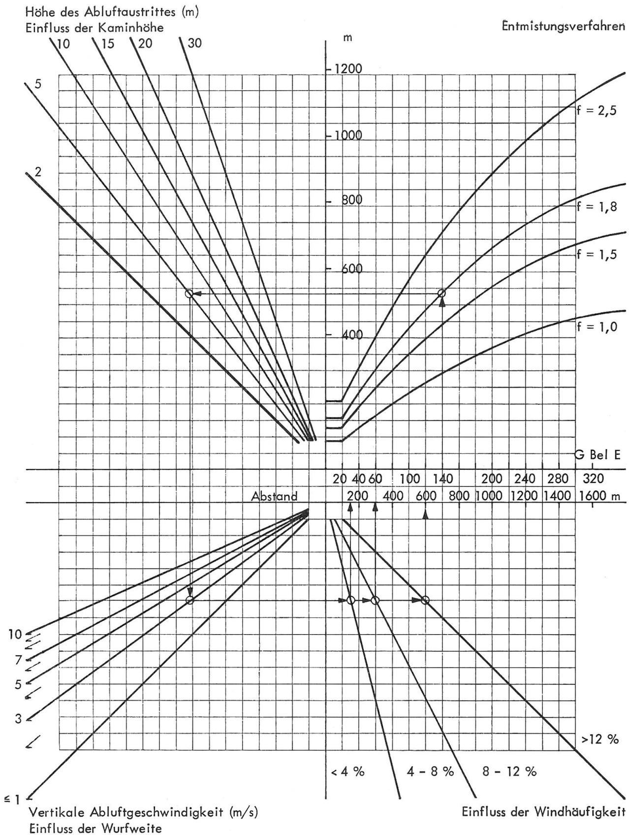
Abb. 9: Geruchsemission landw. Betriebsgebäude. Abstand zur nächsten Wohnsiedlung. Beispiel: 140 G Bel E, Flüssigmistlagerung im geschlossenen Stall  $f$ , 1,8, Kaminhöhe 5 m, vertikale Luftgeschwindigkeit 3 m/s.
