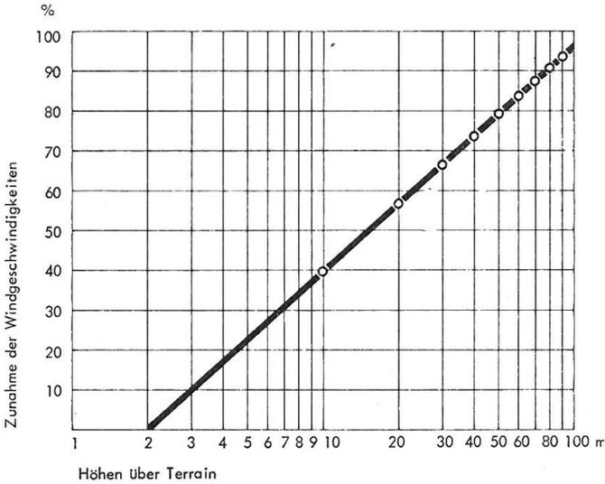
Abb. 4: Zunahme der Windgeschwindigkeiten in der Höhe in Prozenten der Windgeschwindigkeiten auf dem Niveau 2 m über Terrain.
