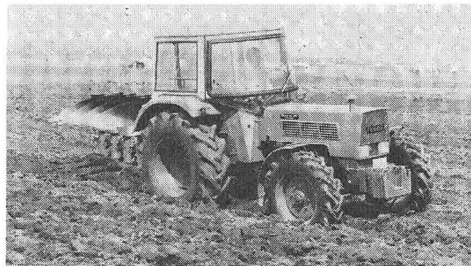
Serienmässig ist die hydraulische Servolenkung eingebaut und die grosse Bereifung vorne und hinten (7.50–20 und 14–34) gehört zur Grundausrüstung.
