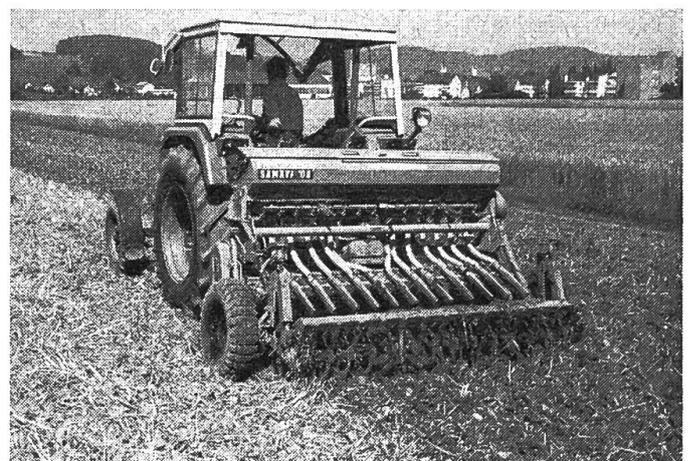
Abb. 12: Die pfluglose Frässaat, für die eine Frässämaschine benützt wird, bewährte sich insbesondere für den Zwischenfutterbau (Abb.) und für den Weizenbau nach Hackfrüchten und Mais.
