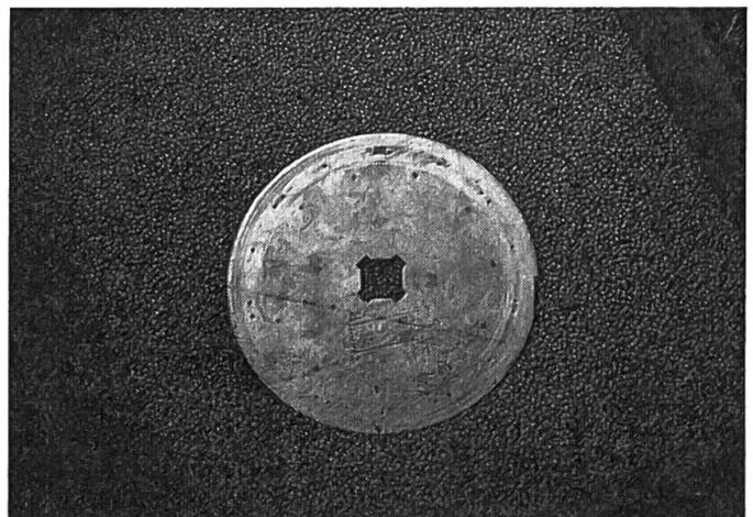
Abb. 22: Für die Wechselfaat hergerichtete Säscheibe eines pneumatischen Einzelkornsäugerätes.
