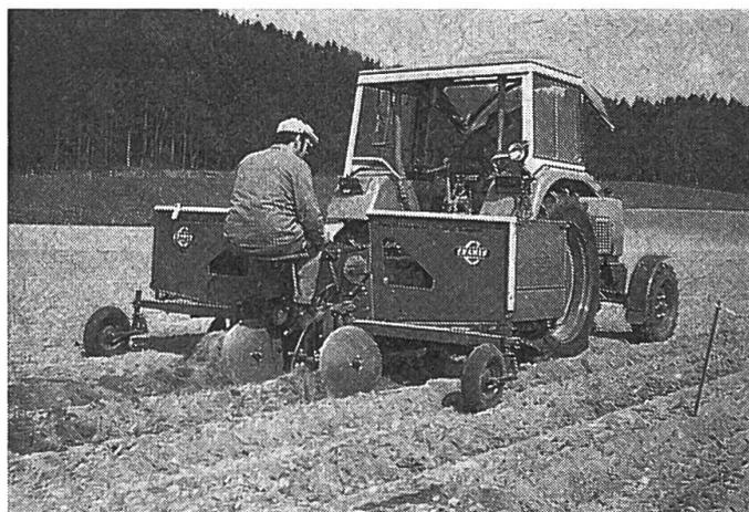
Abb. 24: Zweireihiger Vierfachbecher-legeautomat. Die Regelung der rollbodenartigen Zufuhrorgane erfordern eine Bedienungsperson.
