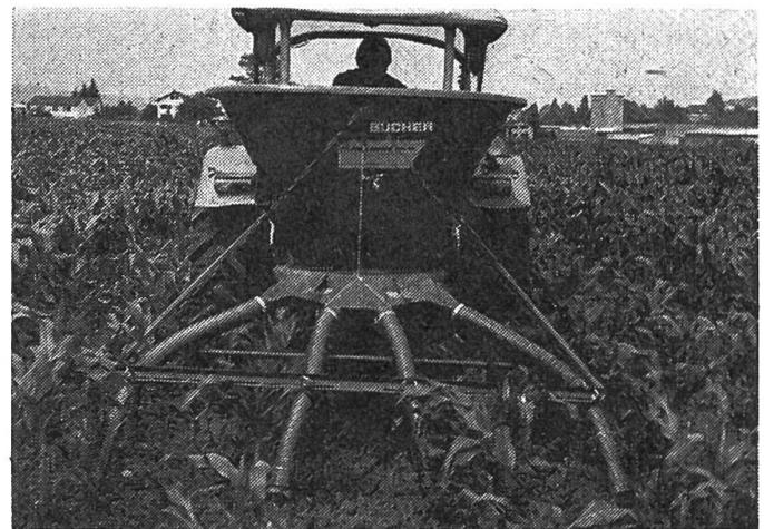
Abb. 18: Zweiseiben-Schleuderstreuer mit vierreihiger Reihenstreuervorrichtung bei Mais-Unterblatt-düngung.
