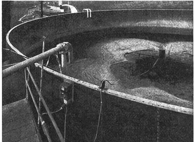
Abb. 6: Jauche-Belüftungsgerät
