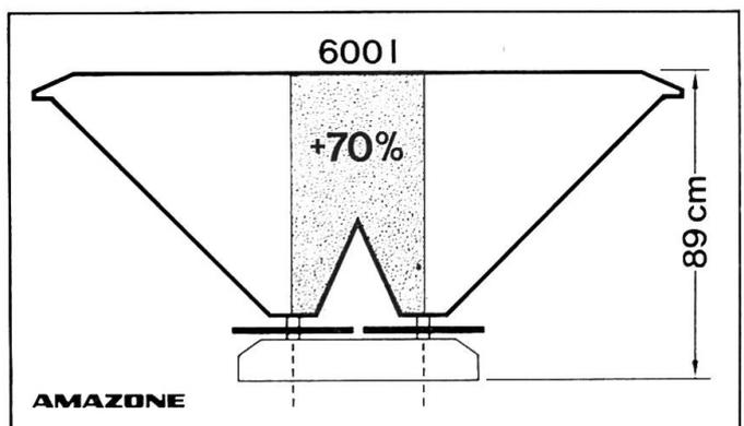
Zweischeibenstreuer ermöglichen gegenüber Einscheibenbauart zusätzlichen Behälterinhalt (schraffiert). Dadurch kann bei Flachbauweise die Wandneigung noch so steil bleiben, dass alle gekörnten und kristallinen Sorten sicher nachrutschen.
