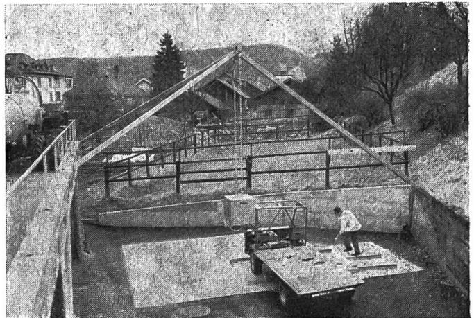
Abb. 1: Prüfstand für Pendelschlagversuche
