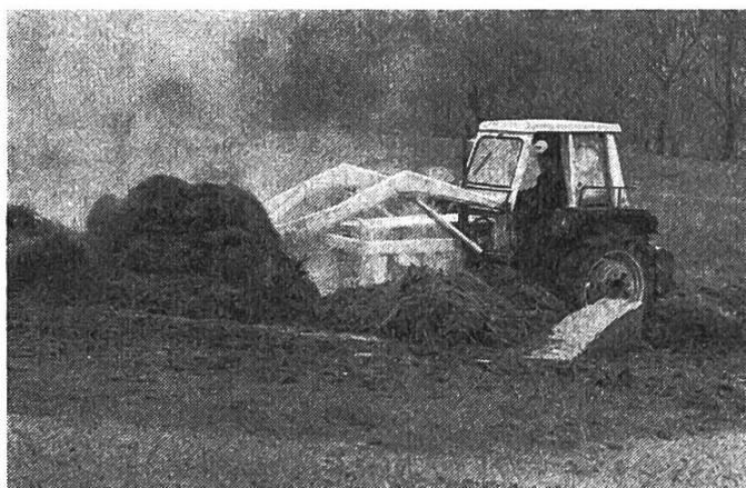
Abb. 2: Traktor mit Schnellwechselfrontlader. Der Abbau des ganzen Aggregates geschieht gemäss Abb. 3.
