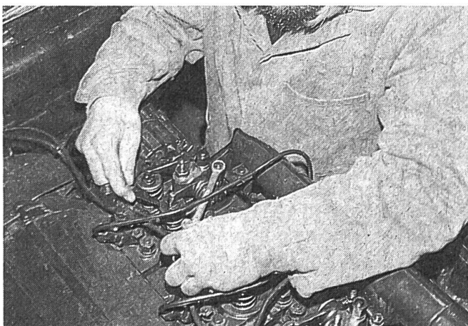
Abb. 3: Sind die Ventile schlecht zugänglich, so wird deren Einstellung resp. Kontrolle gerne vernachlässigt, was zu kostspieligen Reparaturen führen kann. Bei guter Zugänglichkeit, wie in diesem Falle, ist der Zeitaufwand gering.
