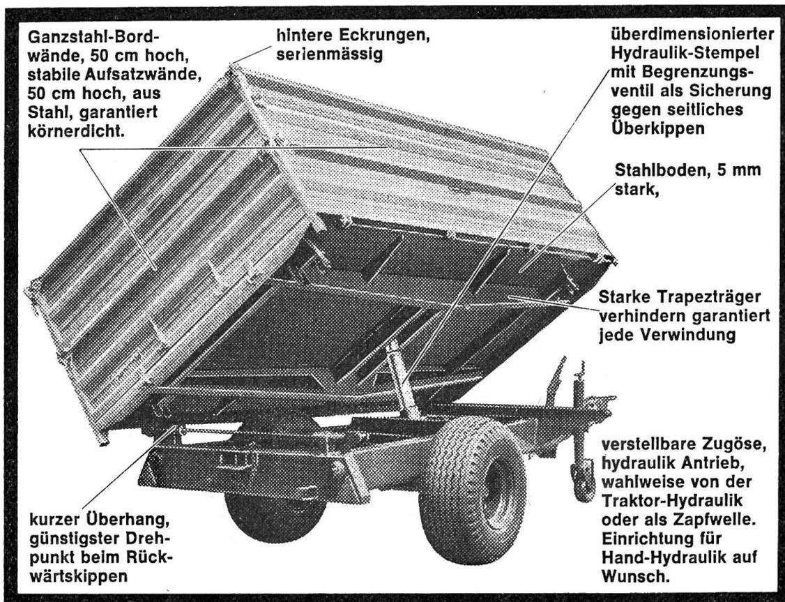
Ganzstahl-Bordwände, 50 cm hoch, stabile Aufsatzwände, 50 cm hoch, aus Stahl, garantiert körnerdicht.
