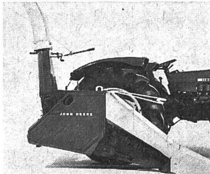
Besondere Kennzeichen: hohe Häckslerleistung bei minimalen Schnittlängen. Wichtige Voraussetzung für gute Silage und höhere Milch- und Fleischerträge: Maisgebisse mit niedrigem Profil, Gummilaschenzwangseinzug. Leistungsstarke Schneidtrommeln mit gehärteten Messern. Bequeme Schnittlängeneinstellung. Eingebaute Messerschleifvorrichtung. Selbst beim Anbaumaishäcksler 25. Separates Gebläse für höhere Auswurfleistung bei den Modellen 35 und 3800.
