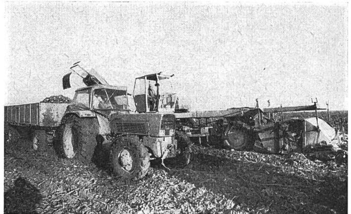
Vom sechsreihigen Selbstfahrer werden die Rüben auf nebenherfahrende Wagen (man kann auch Einachs-Hitchkarren einsetzen) gefördert und zur Feldrandmiete oder sofort zur Zuckerfabrik gefahren. Falls die Witterung günstig ist und die Organisation des Rübenabfahrens klappt, können Stundenleistungen bis zu 1 ha erreicht werden. Foto: Dr. W. Schiffer
