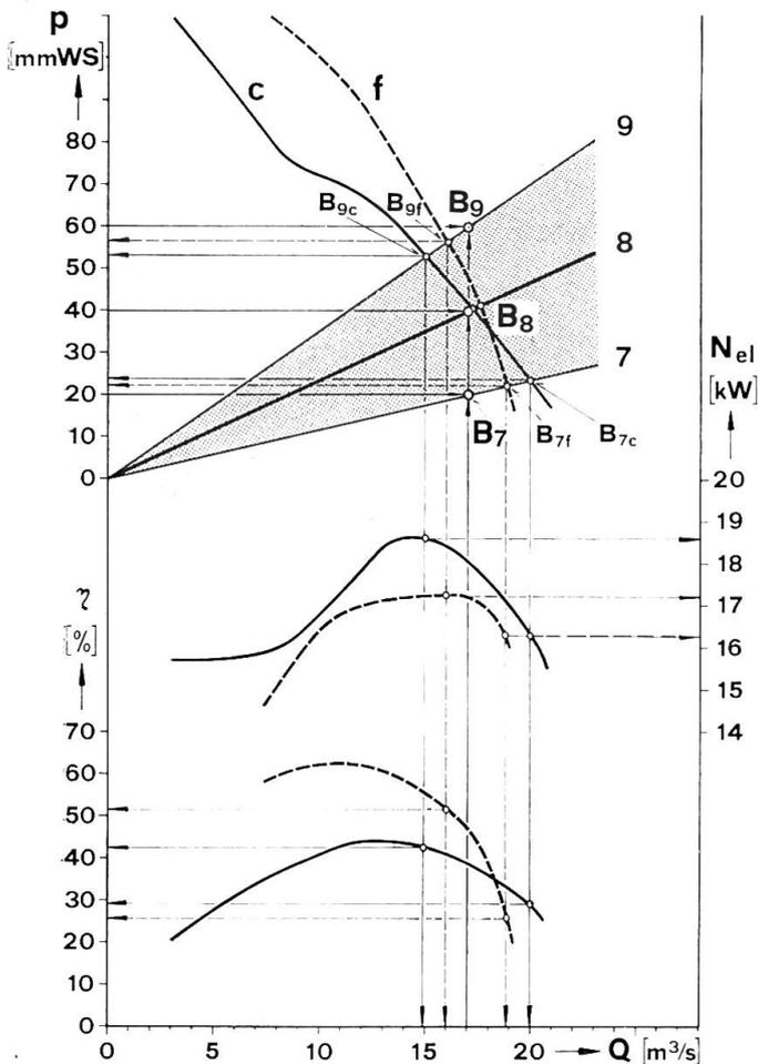
Abb. 6: Vergleich zweier Lüfter mit verschiedenen Kennlinien
