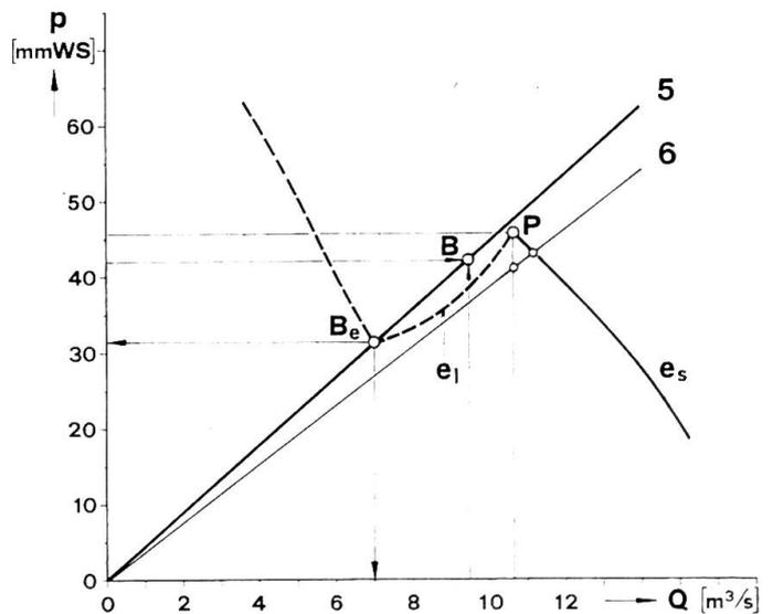
Abb. 5: Beurteilung eines Lüfters mit labilem Betriebsbereich
