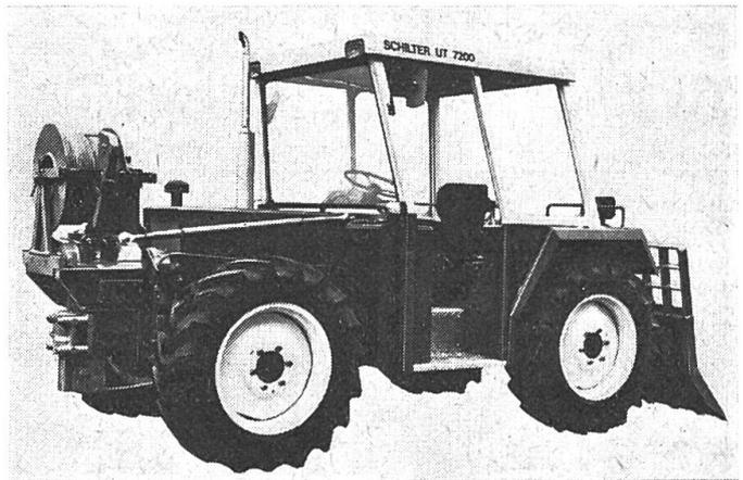
**1 Merk-Pullax-Seilspill**, zum Antrieb durch Zapfwelle.
