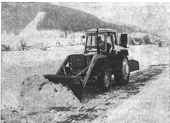
Abb. 2: Kombination von Schneefräse und Frontlader-Schneeräumschild.
