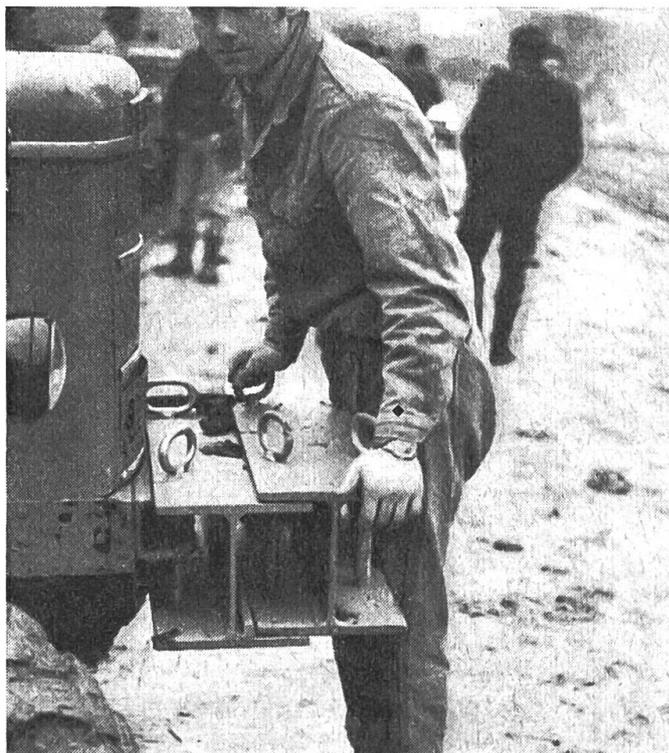
Abb. 1: Aus H-Eisen selbst hergestellte Frontgewichte.
