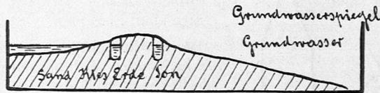
Nun folgt eine Betrachtung über die Anlage von Sodbrunnen an Hand von Faustskizzen, die unter Mithilfe der Schüler an der Tafel entstehen. (Siehe nachfolgende Figur.) Graben eines Schachtes bis unter den Grundwasserspiegel, ausmauern desselben, um ihn vor Zusammensturz zu schützen. Liegt der
