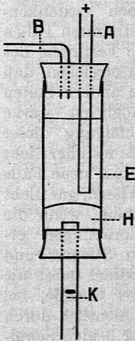
Dieser Versuch ist auch insofern lehrreich, als das Elektrolysegefäß, nachdem eine kurze Zeit elektrolysiert worden ist, nach Ausschalten der angelegten Spannung eine Klemmenspannung von über 3 Volt anzeigt, d. h. das Elektrolysegefäß ist ein galvanisches Element aus Natrium, Kohle und Kochsalzlösung geworden. Der Versuch eignet sich also infolge des großen Lösungsdruckes des Natriums auch gut zur Demonstration einer großen Polarisationsspannung.
