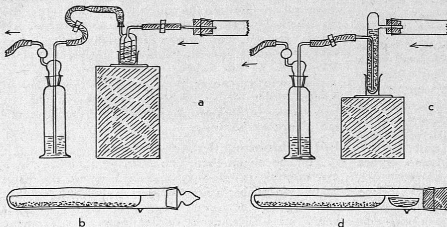
wird der Ofen eine Stunde lang auf 1100° angeheizt, so dass das Kohlendioxyd sich abspaltet und mit dem Luftstrom in den Kaliapparat übergeht. Nach dem Ausschalten des elektrischen Stromes lässt man den Ofen während 25 Minuten sich abkühlen und schickt
