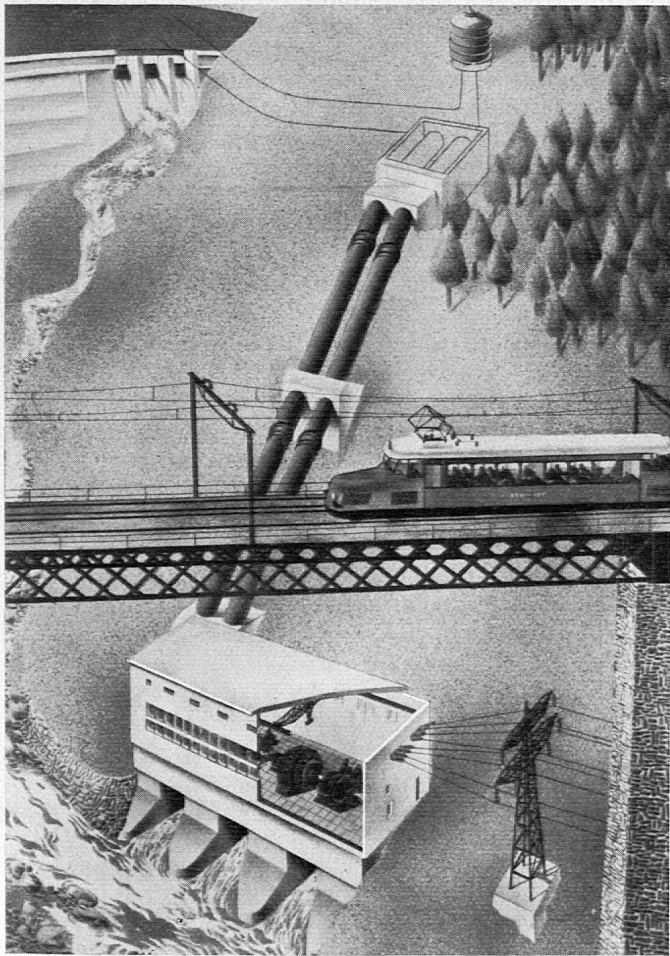
Serie: Industrielle Werke: Hochdruckkraftwerk.
