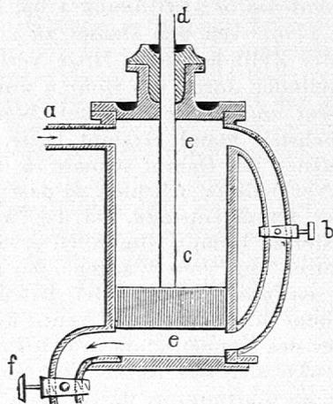
Einfach wirkende Dampfmaschine.
