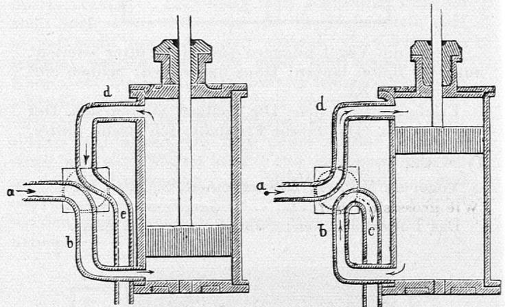
Doppelt wirkende Dampfmaschine.
