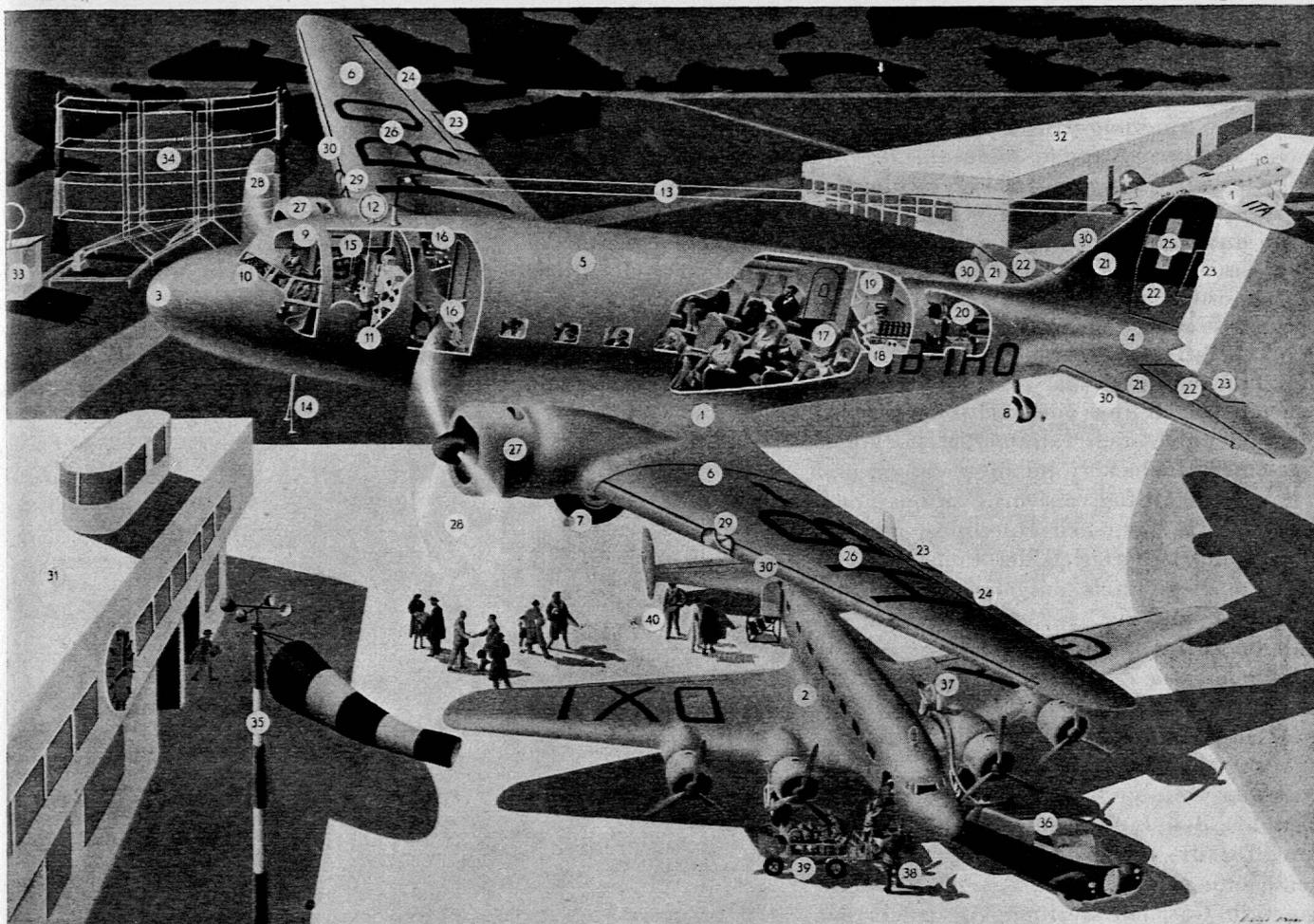
1. 2motoriger Ganzmetall-Tiefdecker mit einfachem Leitwerk.
