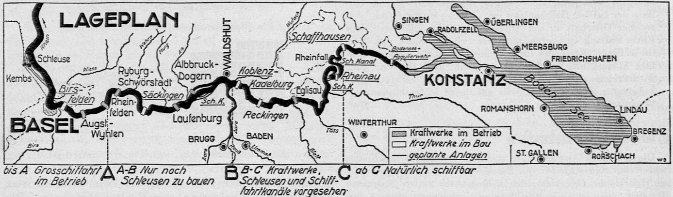
5. Warum nur bis Basel Schifffahrt? Der Plan zur Schiffbarmachung des Rheines von Basel bis zum Bodensee ist schon alt, aber konnte bis heute leider noch nicht durchgeführt werden, 1. wegen des grossen Gefälls, welches viel Geschiebe mit sich bringt, und 2. wegen dem grossen Kostenaufwand für die vielen Schleusen und Kanäle.
