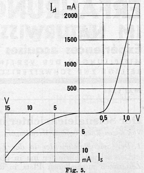
In Fig. 5 sind die Ströme  $I_d$  und  $I_s$  in Abhängigkeit von der Spannung aufgezeichnet. Aus einigen Messungen errechnen wir die Widerstände  $R_d$  und  $R_s$  sowie das Verhältnis  $I_d/I_s$ :
