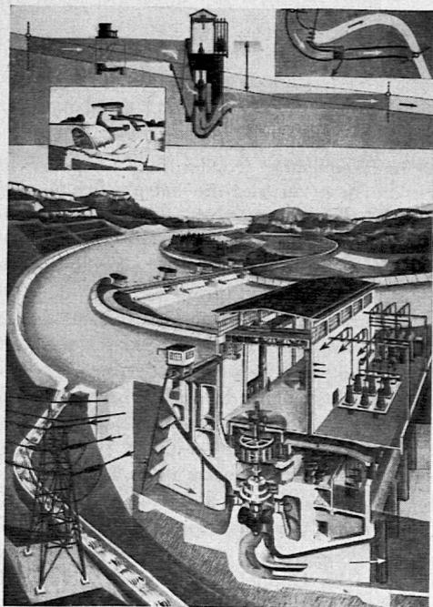
Abb. 2 Niederdruck-Laufwerk
