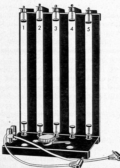
Zum Betrieb der Vakuumskala sind Hochspannungsquellen wie Influenzmaschinen, Bandgeneratoren oder Funkeninduktoren mit Schlagweiten von 10 bis 40 mm völlig ausreichend. Um eine Beschädigung der Röhren zu vermeiden, ist bei grössern Induktoren eine parallele Funkenstrecke von 15 bis 20 mm einzuschalten. Die Umschaltung der Röhren erfolgt durch Betätigung eines Drehknopfes (bei ausgeschalteter Spannung!).
