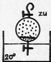
Eine Zuleitung des Ballons wird ganz ins Wasser getaucht. Unterer Hahn *vorsichtig* und nur wenig öffnen. Das langsam einströmende Wasser beginnt sofort, intensiv zu verdampfen. (Der Dampfdruck des Wassers ist bei 20 ° grösser als der Luftdruck im Ballon.) Nach sorgfältig herbeigeführtem Druckausgleich erkennen wir in
