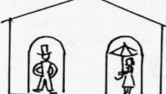
Käufliche Wetterhäuschen mit zwei Figuren beruhen ebenfalls auf diesem Effekt: Die Spannung einer gedrehten Darmseite wird dazu benützt, je nach Luftfeuchtigkeit die Figur mit Schirm oder diejenige ohne Schirm vor das Haus treten zu lassen.
