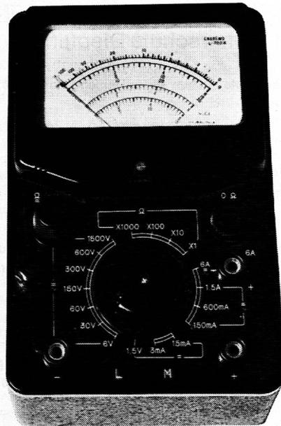
Die Buchsen sind für normale Bananenstecker geeignet. Für alle Messungen, mit Ausnahme des Bereiches 6 A, bleiben die Stecker der Messkabel in den gleichen Buchsen (— und +). Nur für den Bereich 6 A ist eine separate + Buchse zu benutzen.
