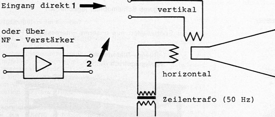
**Horizontalablenkung:** Kippspannung vom Zeilentrafo, Sekundärseite.
