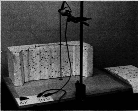
Thermosäge für Schaumstoff aus Reissbrett, Tischklemme, Stativmaterial, Kupplungstück, Isolierklemme und einer unter dem Loch angebrachten Apparatklemme (AK)
