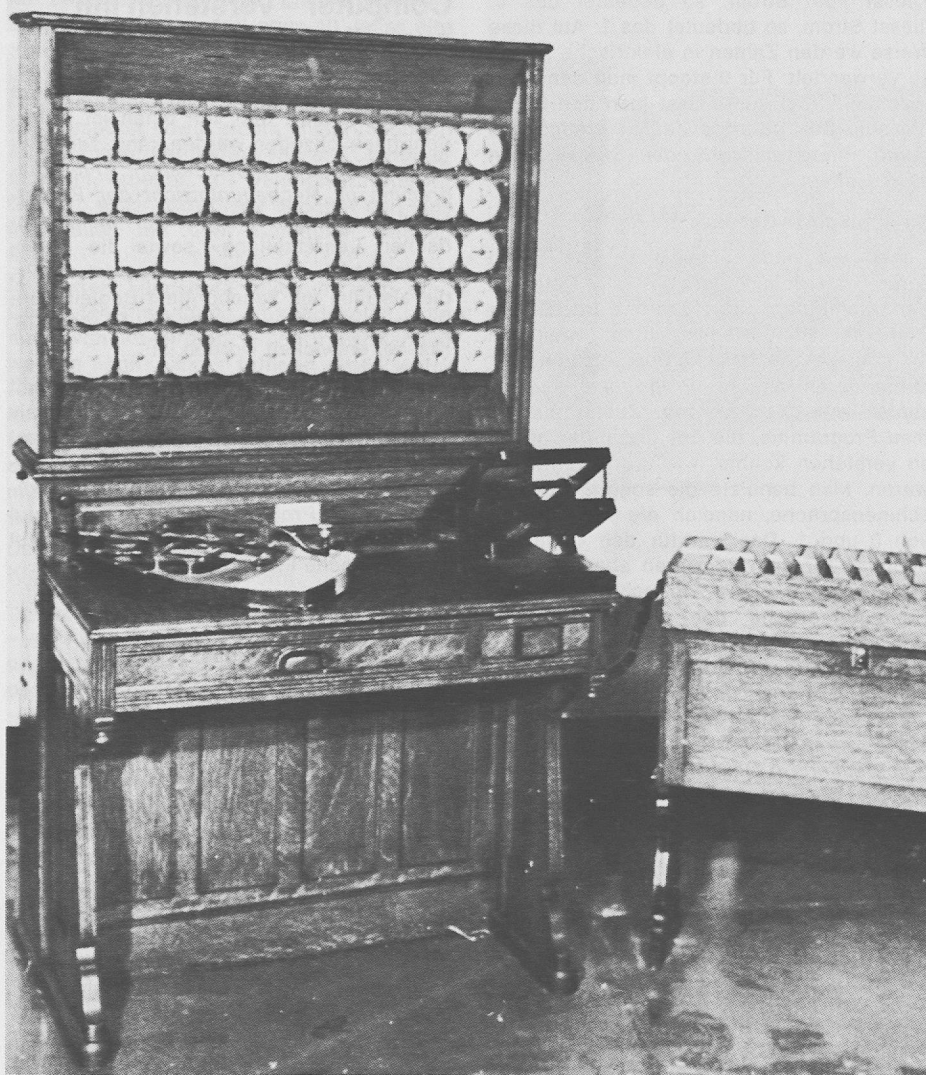
Elektrische Zähl- und Registriermaschine von Hermann Hollerith (vgl. S. 754f.)
