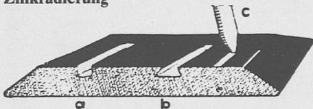
Zinkplatte mit Asphaltlack (Ofenrohrlack) allseitig überzogen (schützt das Metall vor der Säure)
